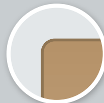
▲ R8: Rundprofil Radius 8 mm
